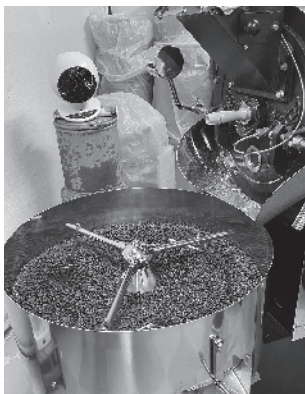
左) 焙煎されたコーヒー豆を攪拌しながら冷まします。/右) 半熱風ガス式焙煎機
